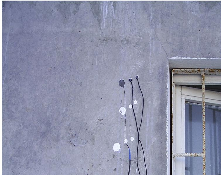
Рис. 4.2 — Измерение плотности теплового потока  $q$ , температуры поверхности  $\tau^{\kappa/\delta}$  керамзитобетонной стеновой панели
