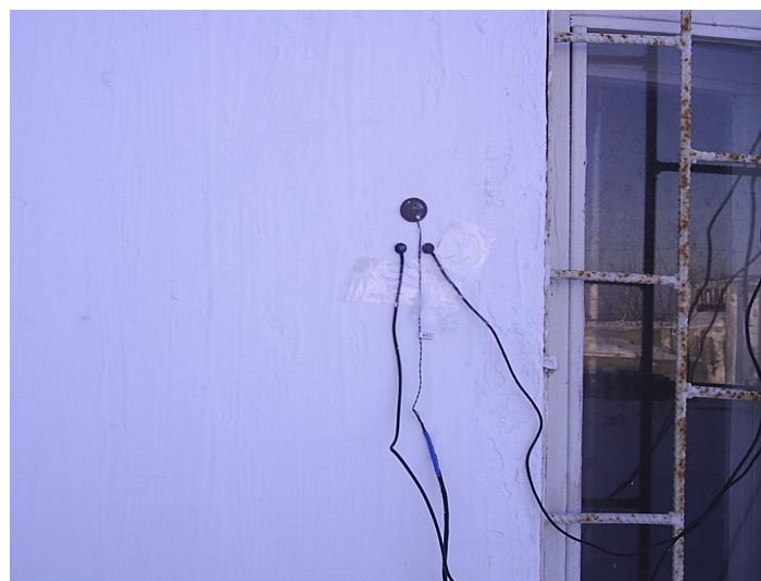
Рис. 4.3 — Измерение плотности теплового потока  $q$ , температуры поверхности  $\tau_k$  "Корунд®"
